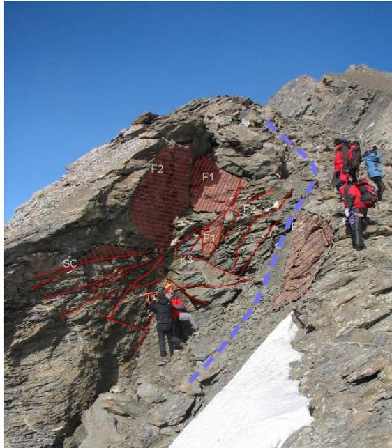
Figura 4.9- Porzione rocciosa del settore meridionale in scivolamento (tratteggio blu) sul sistema F2. Le tracce in rosso evidenziano i diversi sistemi di discontinuità (F2, F1, K3 e sistema di fratturazione parallelo alla scistosità SC).
