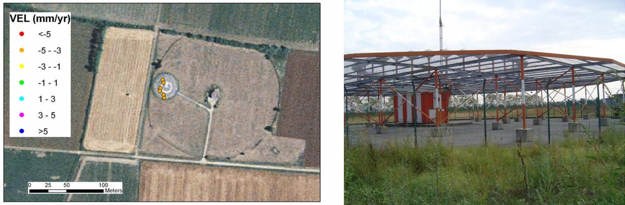
Fig. 2.16. Dataset Valenza: PS in abbassamento in corrispondenza di un'antenna
